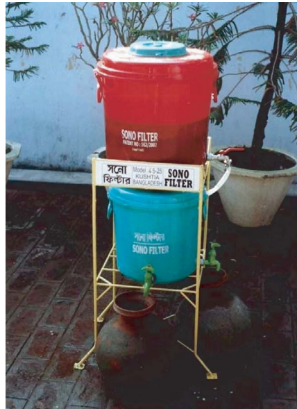
Chapter 12, Figure 1B SONO filter in use.
